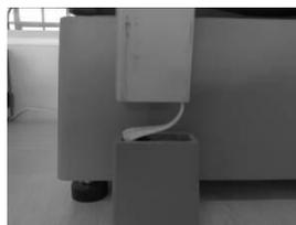
2. 将接好的空中接头塞进显示杆内部
