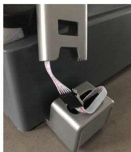
2. 将接好的空中接头塞进显示杆内部
